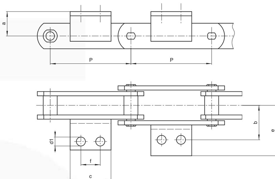
Schema du montage des attaches à la page 1.9/2
